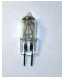
35 Watt 120 Volt T4 Halogen Bulb (GY6.35 Base)
